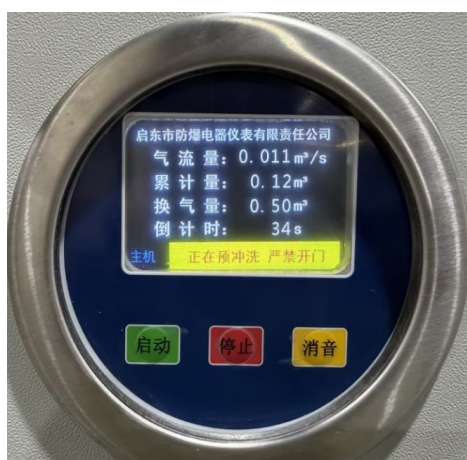
图 6-11: 控制柜吹扫界面下按启动键
