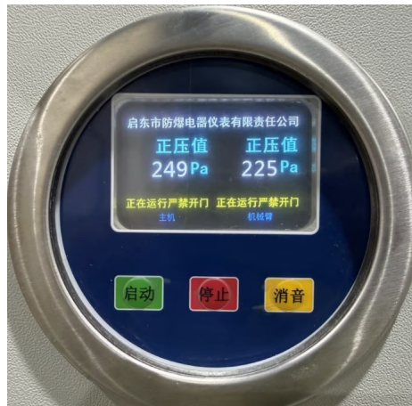
图 6-14: 吹扫完成后长按启动键
