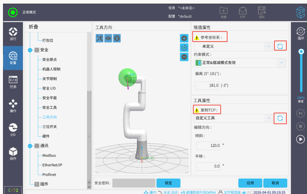
图 3-93: 工具方向界面（坐标系和 TCP 修改后）
