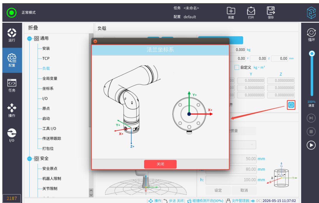
图 3-48: 法兰坐标系方向
