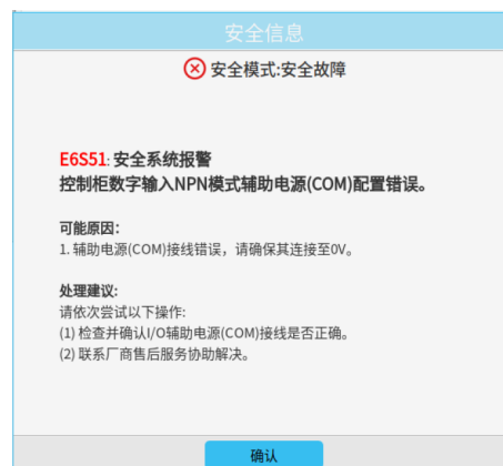
图 2-18: 安全系统报警（NPN）
