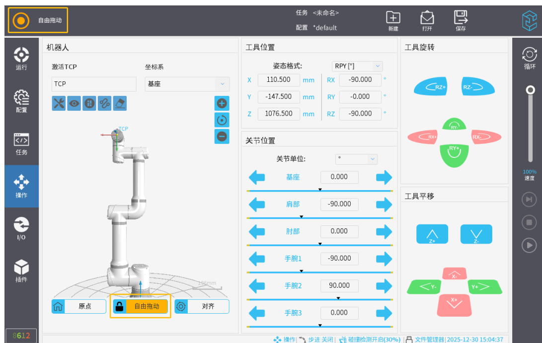
图 3-163: 自由拖动锁定（非锁轴拖动模式下）
