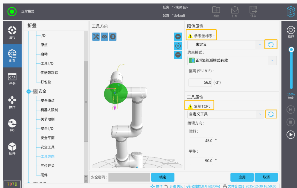
图 3-94: 工具方向界面（坐标系和 TCP 修改后）
