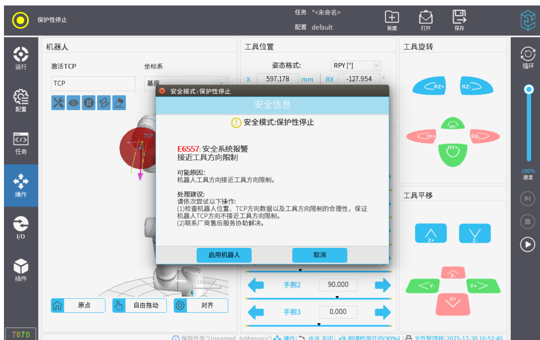
图 3-91: 安全系统报警（接近工具方向限制）
