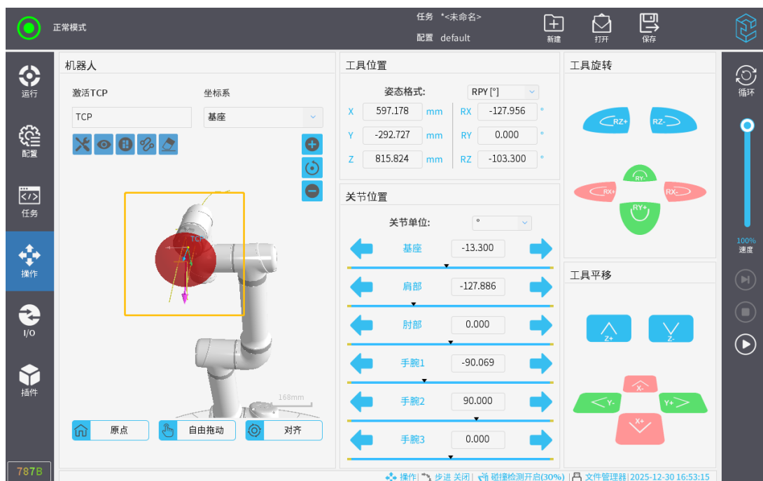
图 3-90: 工具方向模型红色提示
