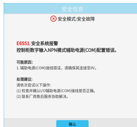
图 2-18: 安全系统报警（NPN）
