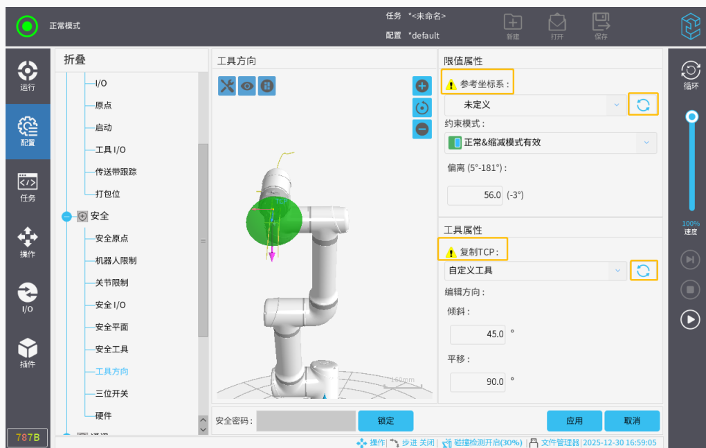
图 3-94: 工具方向界面（坐标系和 TCP 修改后）
