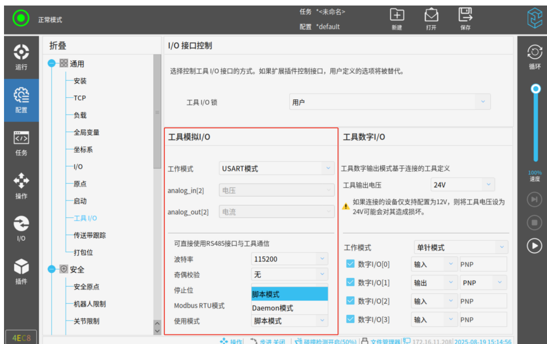
图 3-69: 工具模拟 I/O
