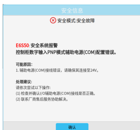
图 2-17: 安全系统报警（PNP）
