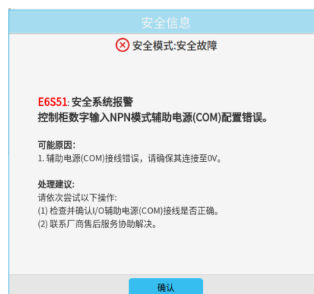
图 2-18: 安全系统报警（NPN）
