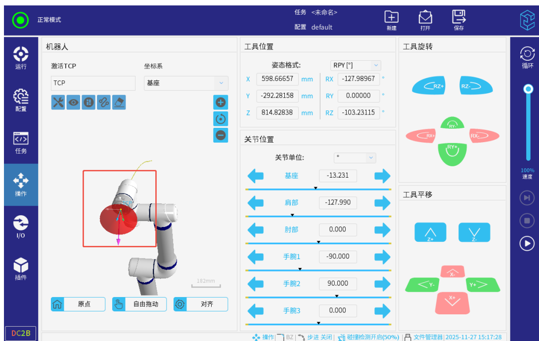
图 3-92: 工具方向模型红色提示
