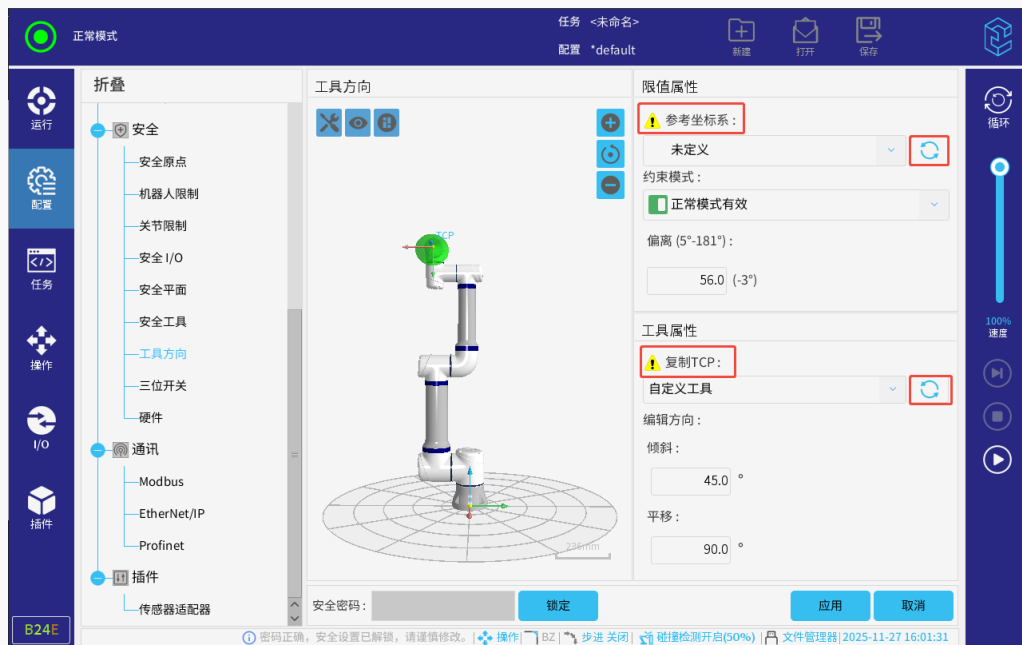
图 3-96: 工具方向界面（坐标系和 TCP 修改后）
