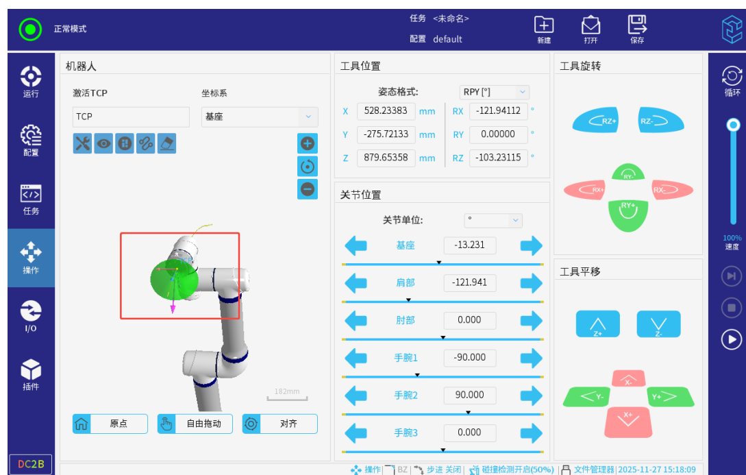
图 3-91: 工具方向模型绿色提示
