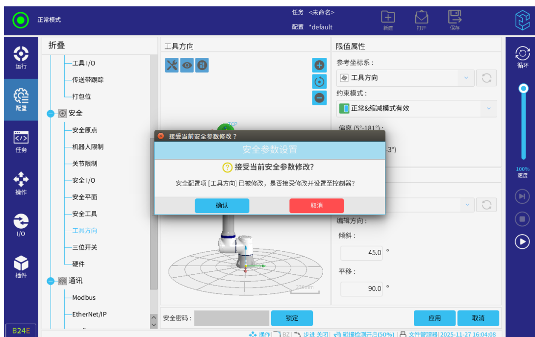
图 3-90: 应用工具方向的配置
