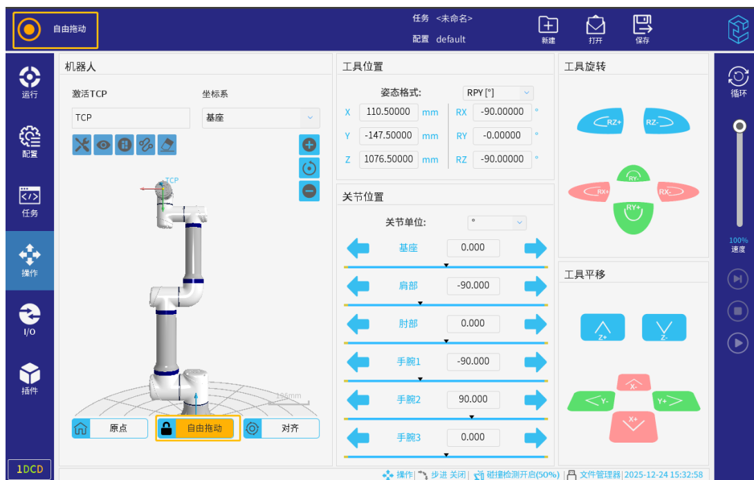
图 3-165: 自由拖动锁定（非锁轴拖动模式下）
