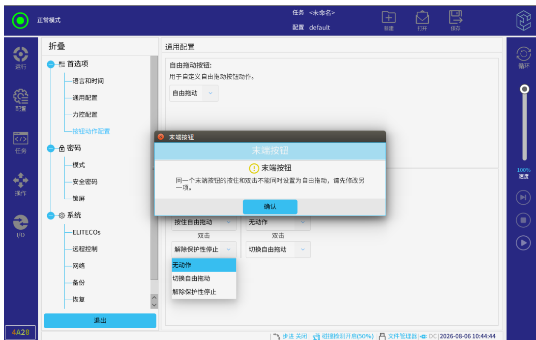
图 3-23: 按钮动作配置冲突
