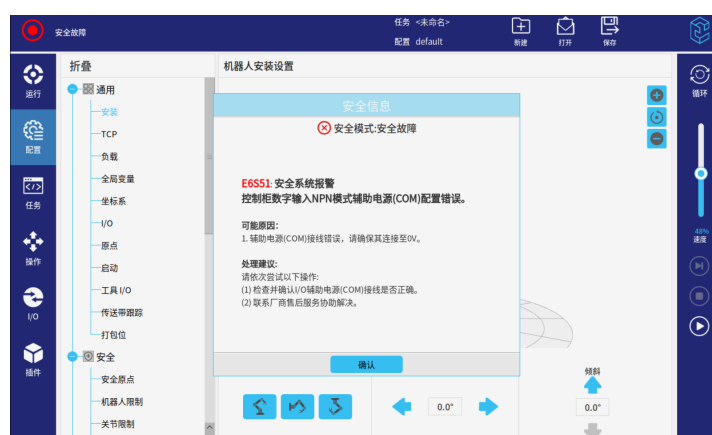
图 2-19: 安全系统报警 (NPN)
