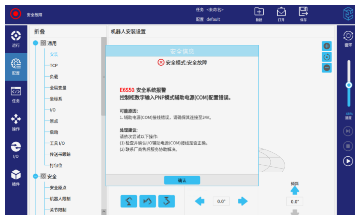
图 2-18: 安全系统报警 (PNP)
