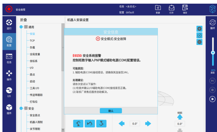
图 2-18: 安全系统报警 (PNP)
