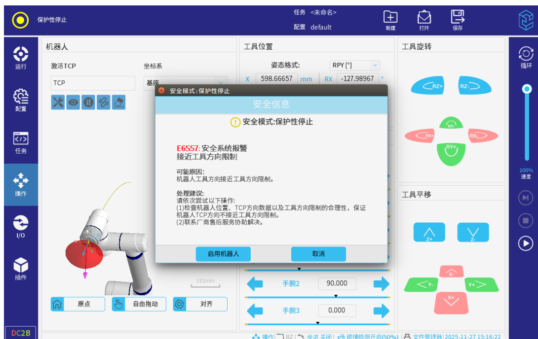
图 3-93: 安全系统报警（接近工具方向限制）
