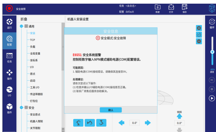
图 2-19: 安全系统报警 (NPN)
