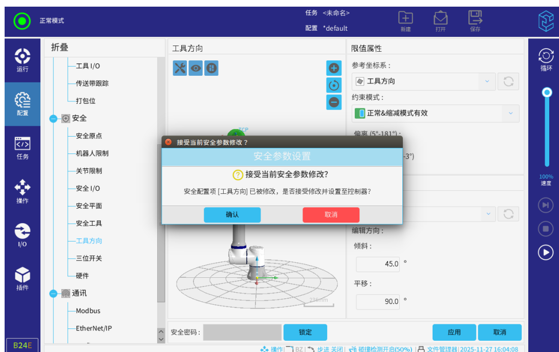
图 3-90: 应用工具方向的配置
