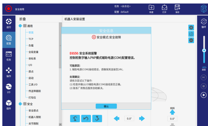
图 2-18: 安全系统报警 (PNP)
