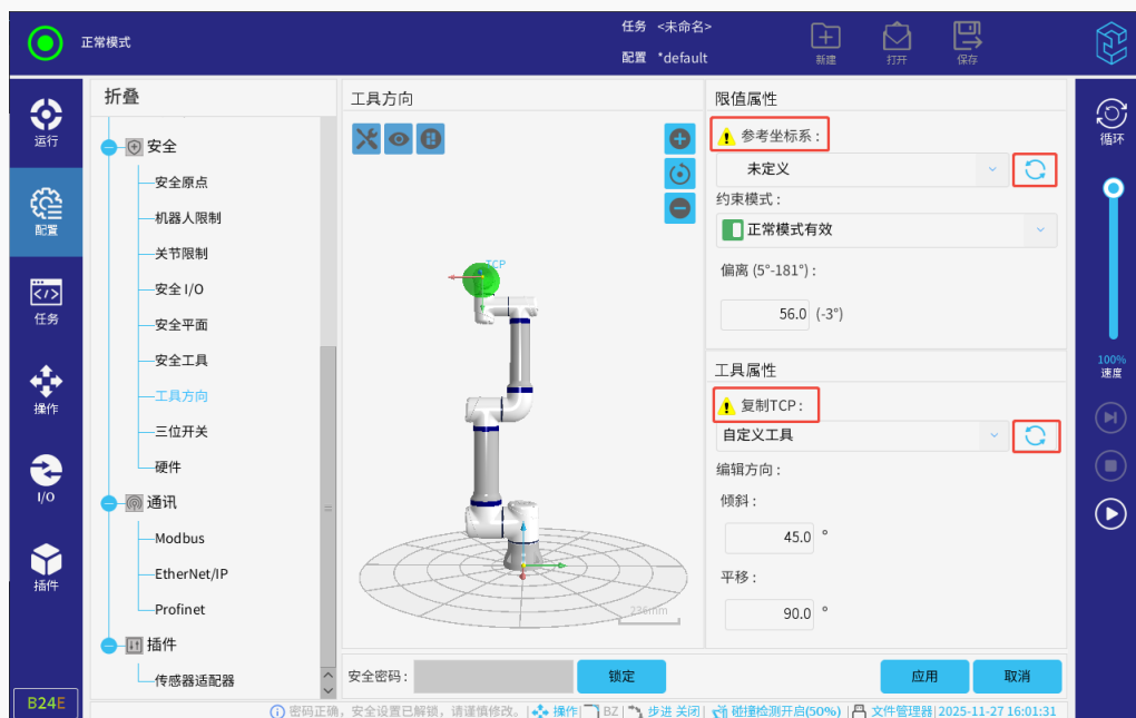
图 3-96: 工具方向界面（坐标系和 TCP 修改后）
