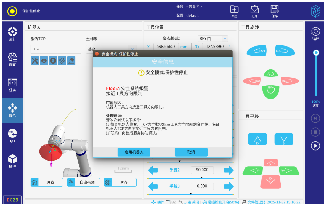
图 3-93: 安全系统报警（接近工具方向限制）
