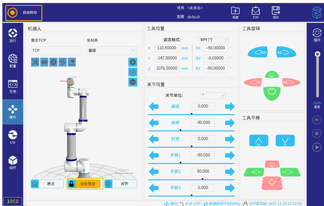
图 3-165: 自由拖动锁定（非锁轴拖动模式下）
