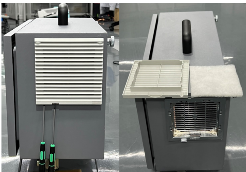
图 2-3: 控制柜过滤器拆装
