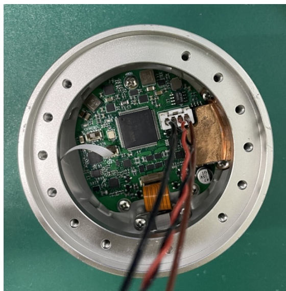
图 3-16: 连接手腕 3 关节和末端法兰的电线
