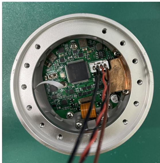
图 3-16: 连接手腕 3 关节和末端法兰的电线
