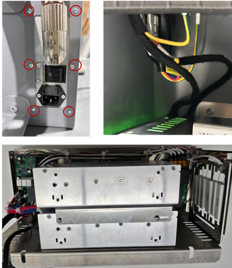
图 3-26: 螺钉位置、电源接地连接位置及钣金模块放置方式
