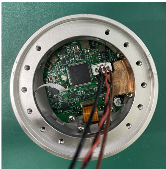
图 3-16: 连接手腕 2 关节和末端法兰的电线
