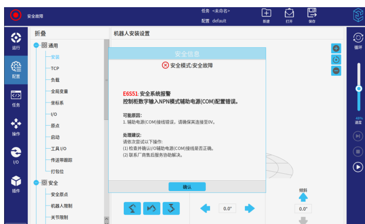
图 5-7: 安全系统报警 (NPN)
