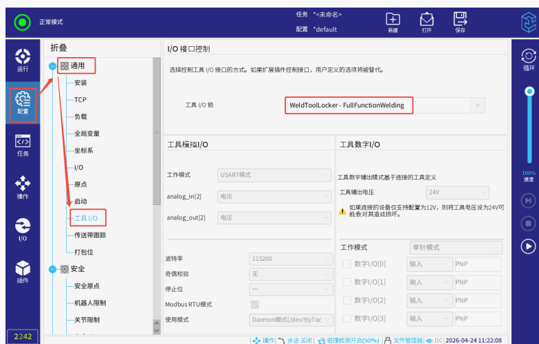
图 3-2: 设置工具 I/O 锁
