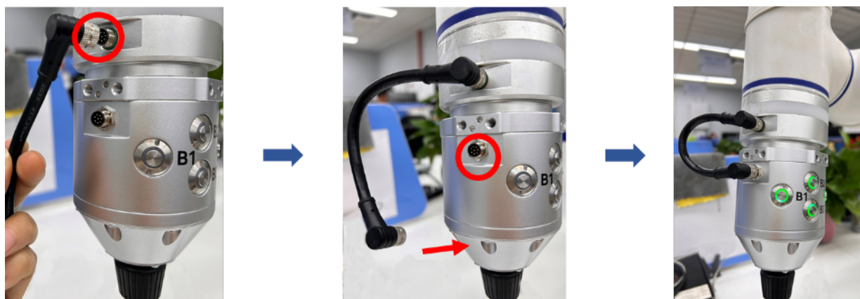
图 2-3: 连接机器人末端示意图
