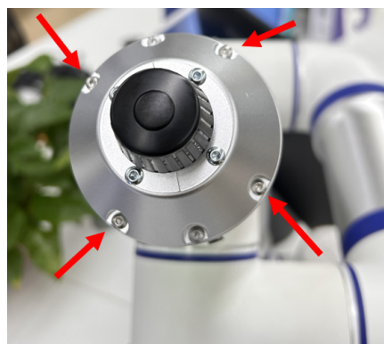
图 2-2: Elite Co-Pilot 工具安装示意图
