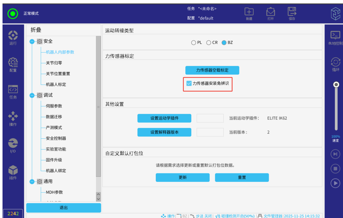
图 3-18: 力传感器安装角辨识
