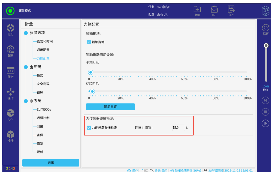
图 3-29: 开启力传感器碰撞检测
