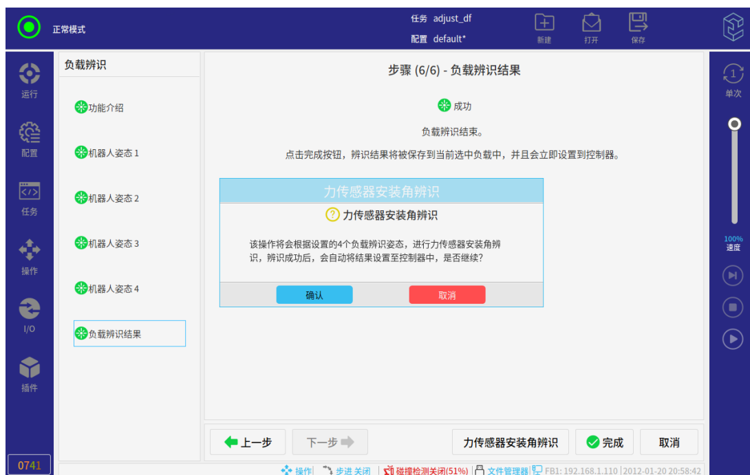
图 3-20: 将辨识结果写入控制器
