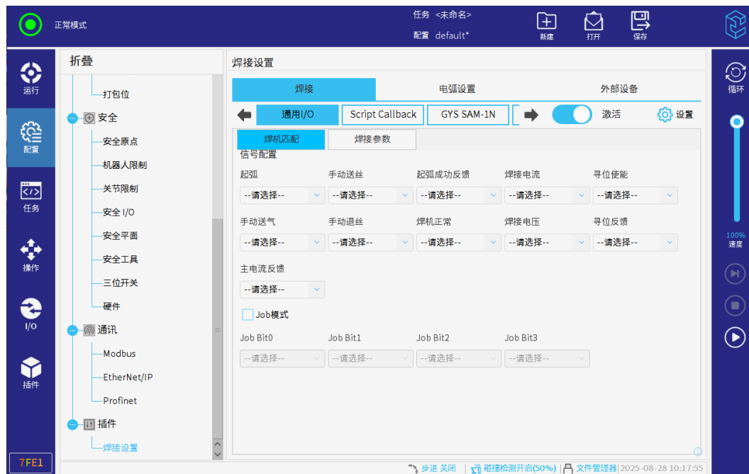
图 3-2: 通用 I/O-焊机匹配
