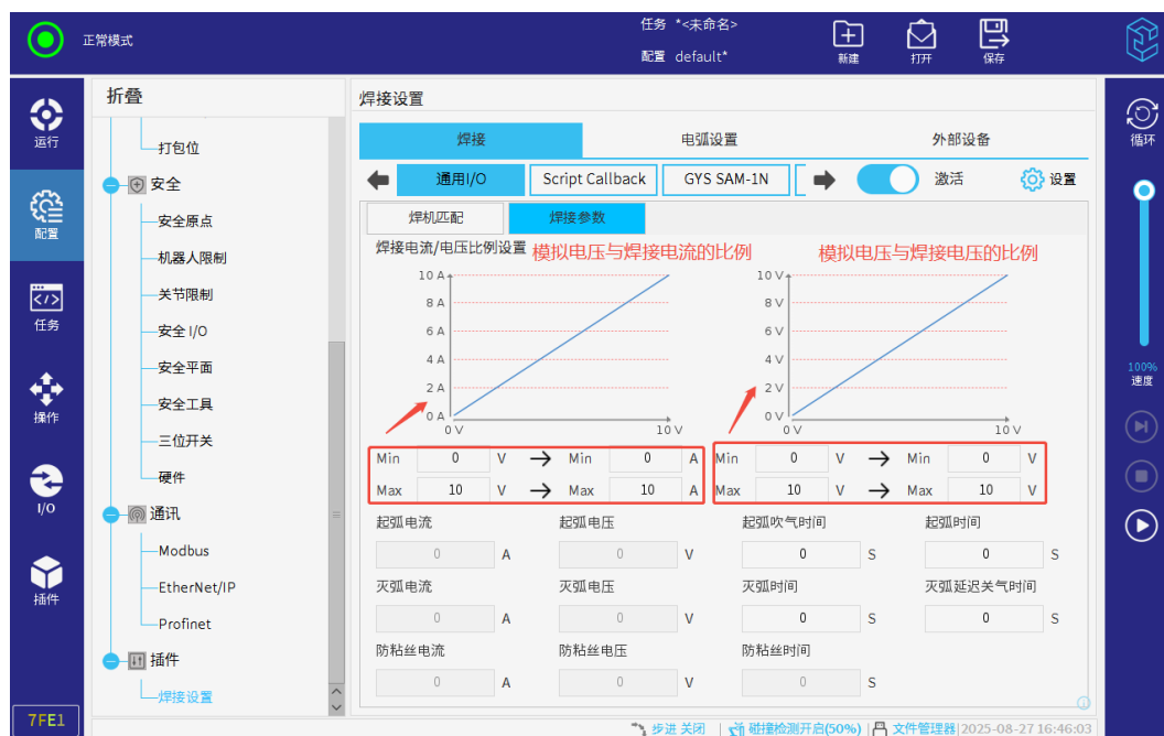
图 3-5: 焊接电流/电压比例设置
