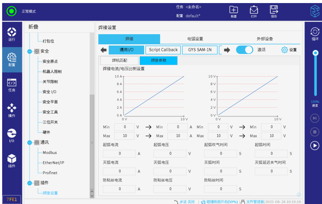
图 3-4: 通用 I/O-焊接参数
