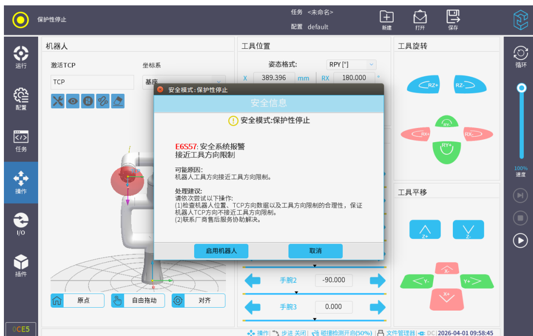
图 3-86: 安全系统报警（接近工具方向限制）
