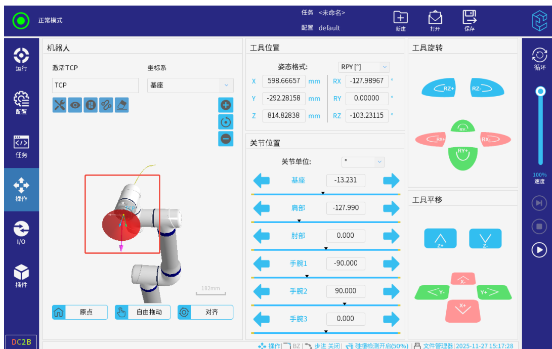
图 3-88: 工具方向模型红色提示
