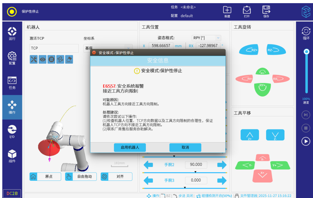
图 3-89: 安全系统报警（接近工具方向限制）
