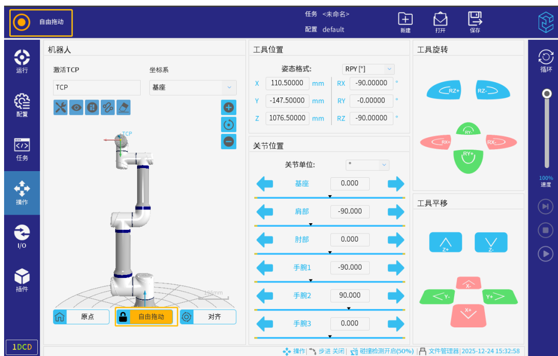
图 3-161: 自由拖动锁定（非锁轴拖动模式下）
