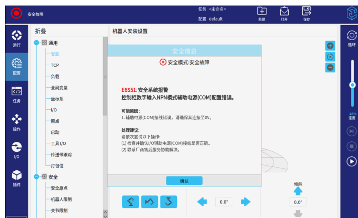
图 2-19: 安全系统报警 (NPN)
