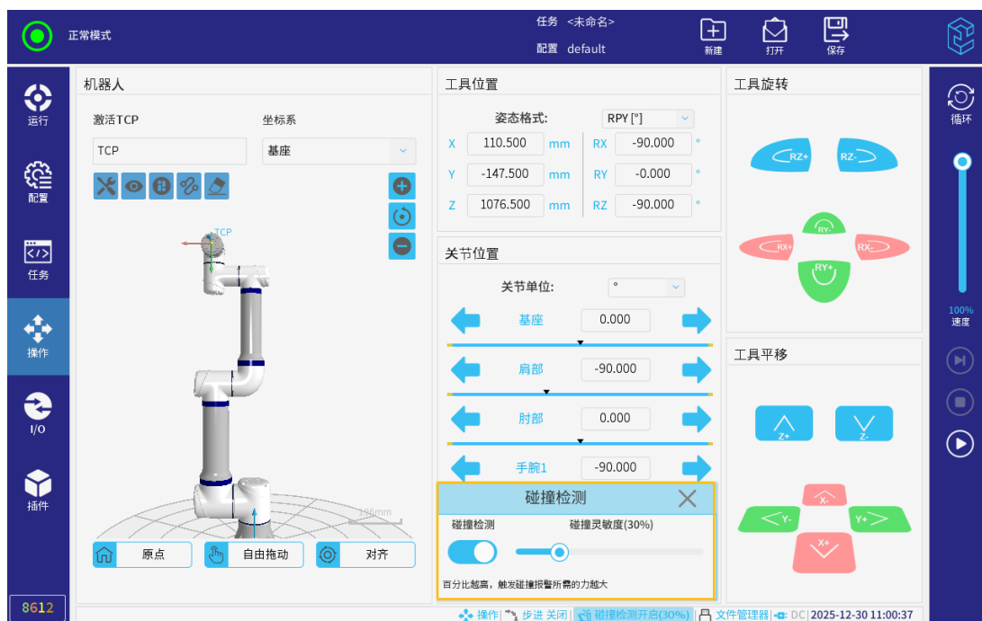
图 3-14: 开启碰撞检测
