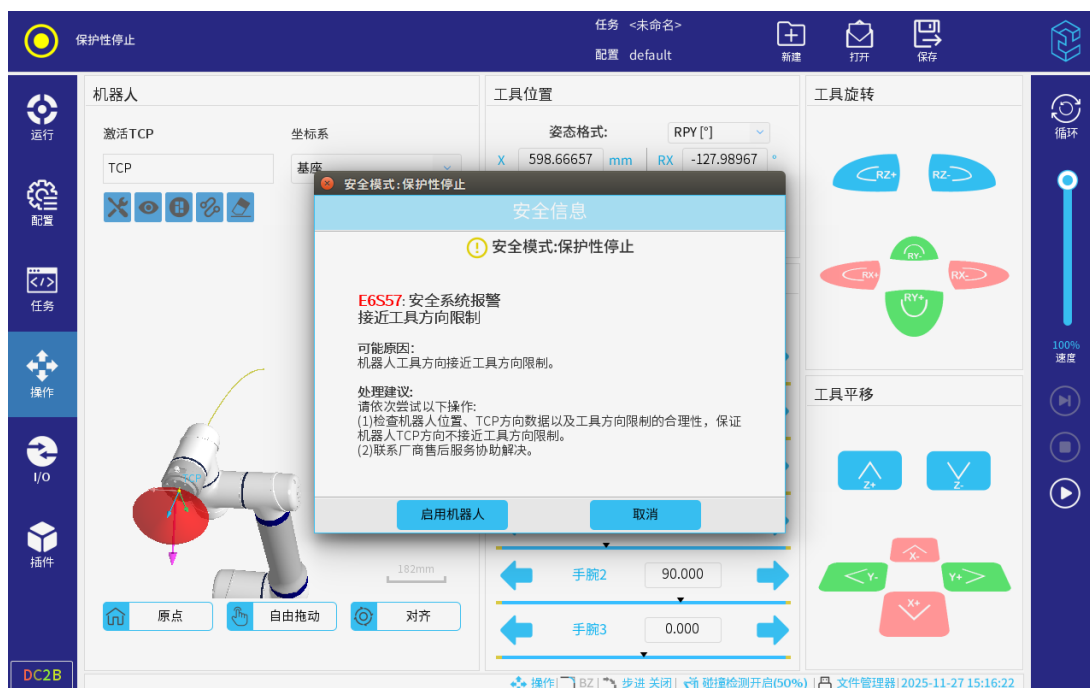
图 3-89: 安全系统报警（接近工具方向限制）
