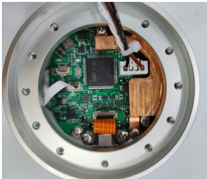
图 3-16: 连接手腕 3 关节和末端法兰的电线
