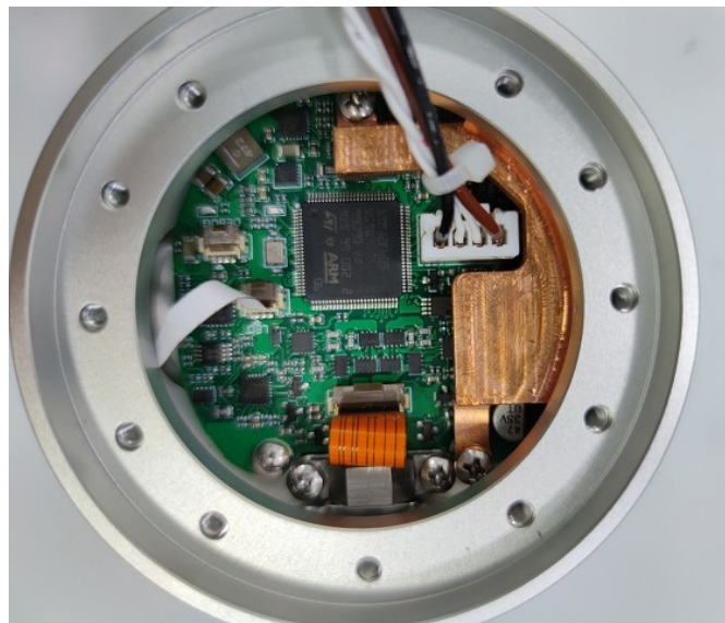
图 3-16: 连接手腕 3 关节和末端法兰的电线
