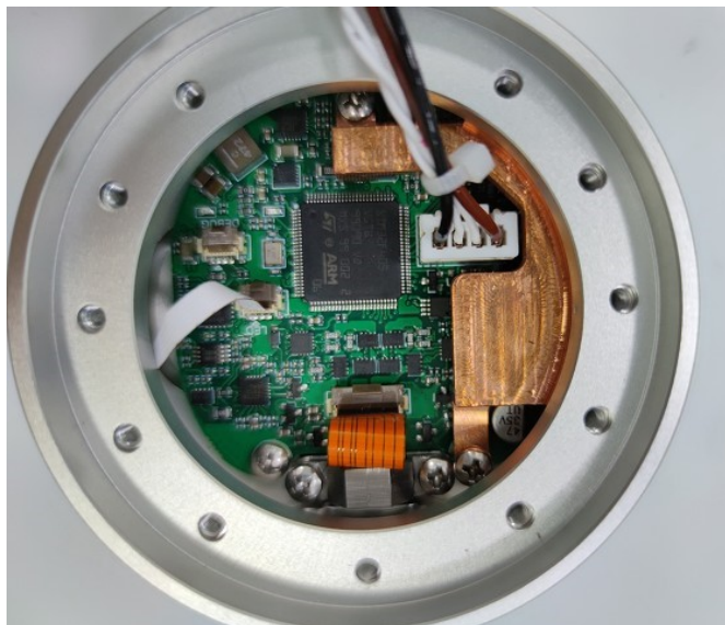
图 3-16: 连接手腕 3 关节和末端法兰的电线
