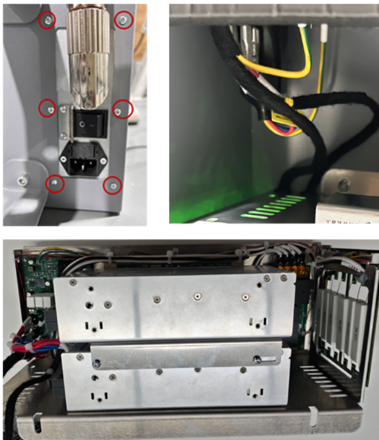
图 3-25: 螺钉位置、电源接地连接位置及钣金模块放置方式
