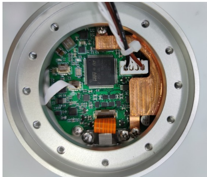
图 3-16: 连接手腕 3 关节和末端法兰的电线
