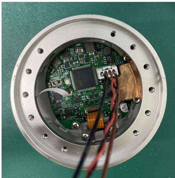
图 3-16: 连接手腕 3 关节和末端法兰的电线
