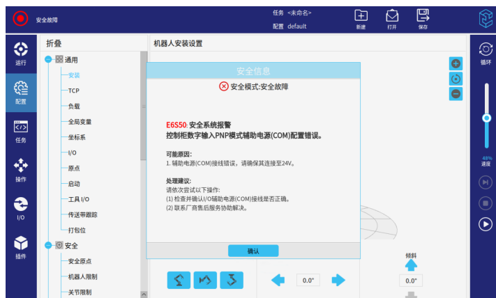
图 5-6: 安全系统报警 (PNP)
