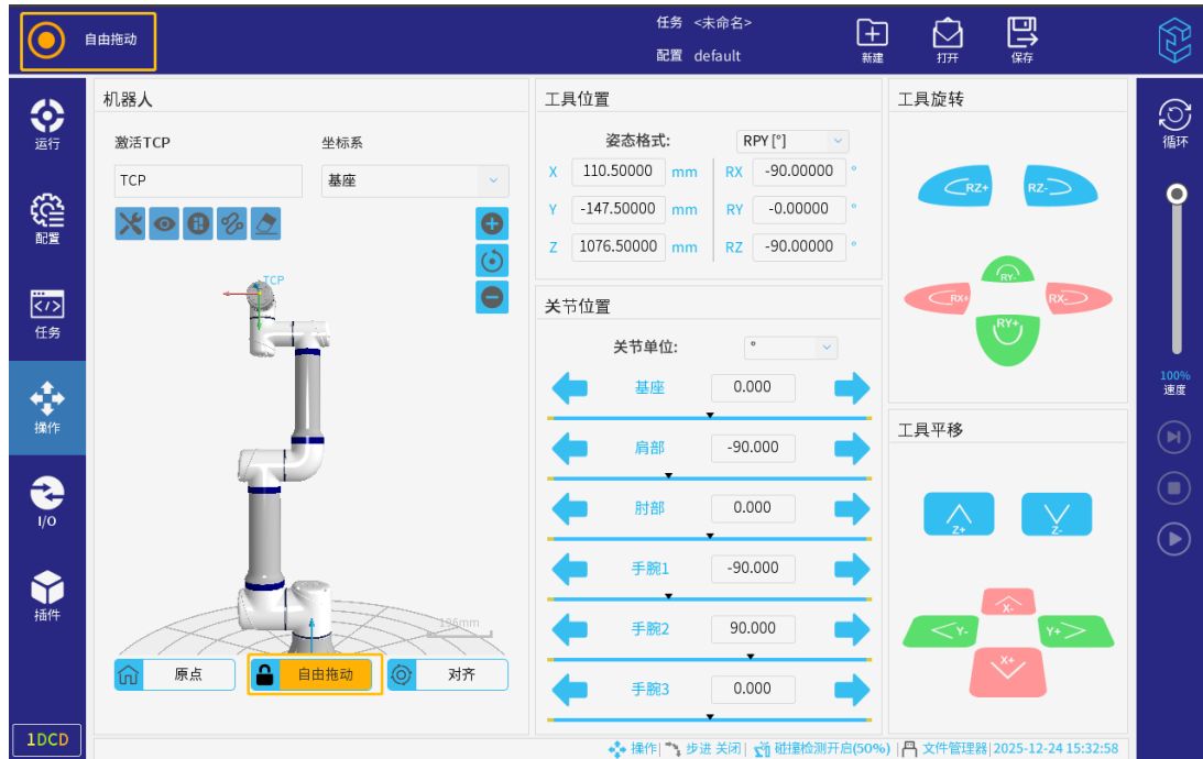
图 3-158: 自由拖动锁定（非锁轴拖动模式下）
