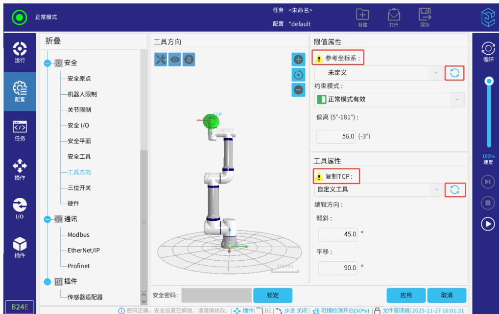
图 3-89: 工具方向界面 (坐标系和 TCP 修改后)
