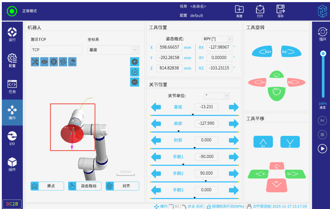
图 3-85: 工具方向模型红色提示
