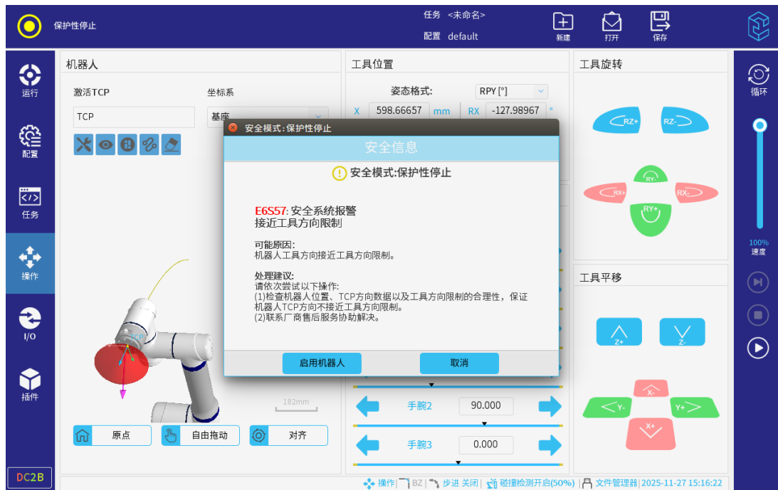
图 3-86: 安全系统报警（接近工具方向限制）
