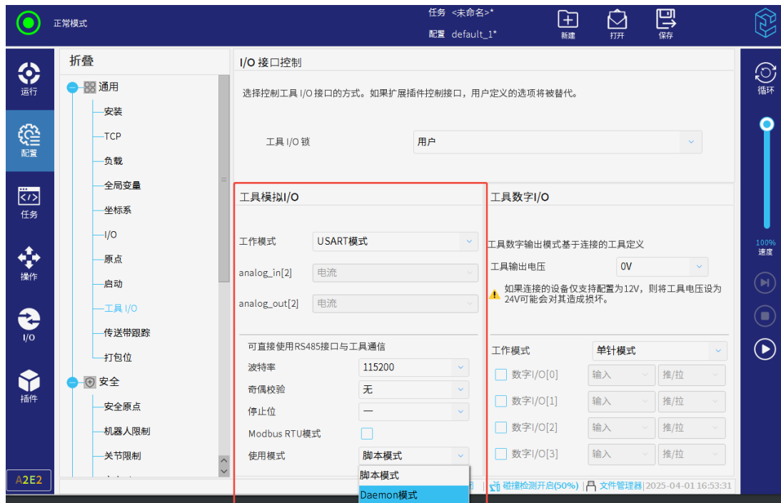
图 3-66: 工具模拟 I/O
