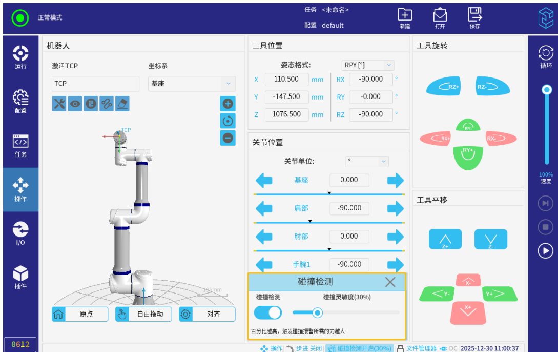
图 3-13: 开启碰撞检测
