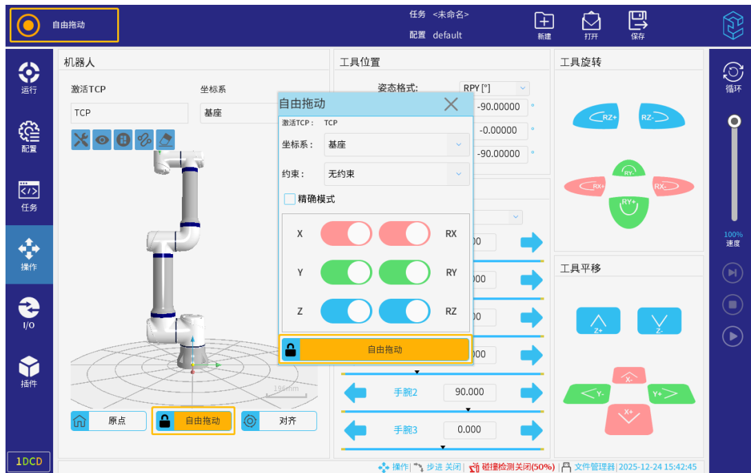
图 3-159: 自由拖动锁定（锁轴拖动模式下）
