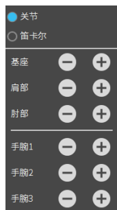
图 2-37: 轴运动控制按键（关节）
