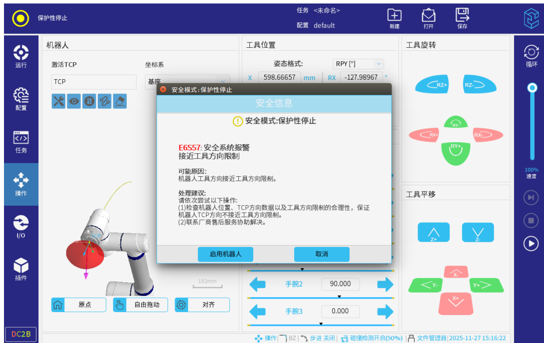
图 3-86: 安全系统报警（接近工具方向限制）
