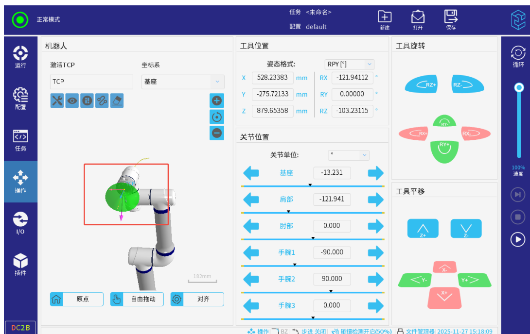
图 3-84: 工具方向模型绿色提示
