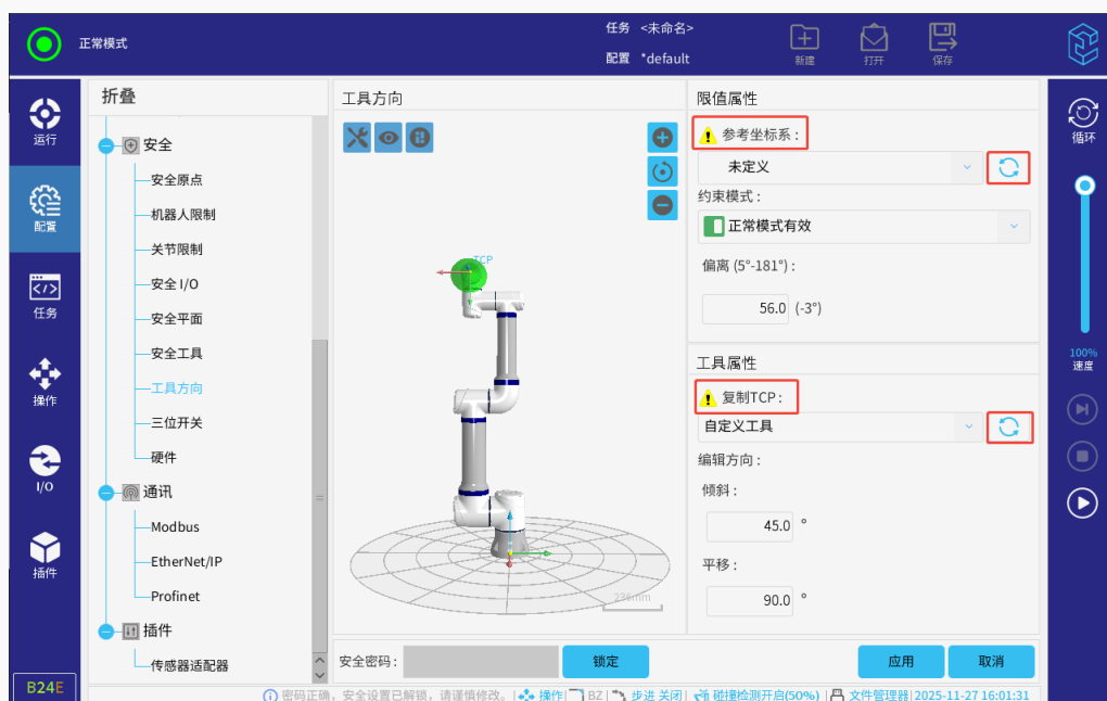
图 3-89: 工具方向界面（坐标系和 TCP 修改后）
