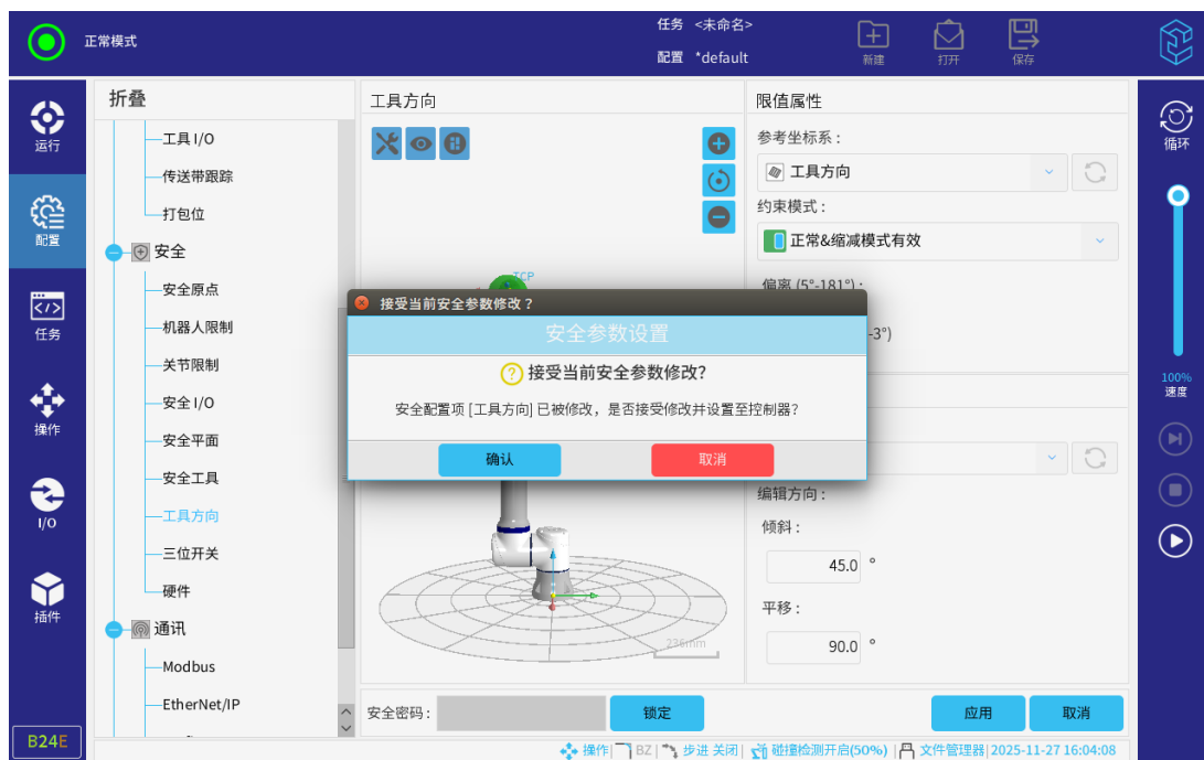
图 3-83: 应用工具方向的配置
