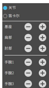
图 2-37: 轴运动控制按键（关节）
