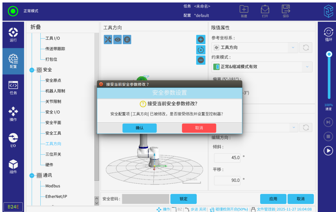
图 3-83: 应用工具方向的配置
