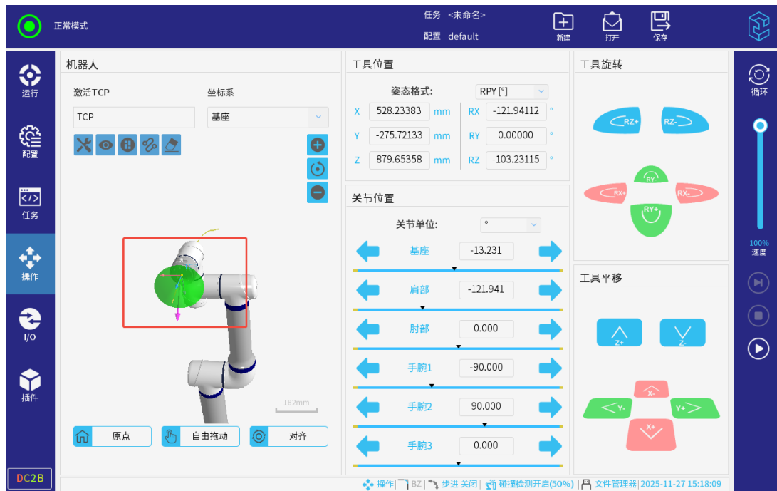
图 3-84: 工具方向模型绿色提示
