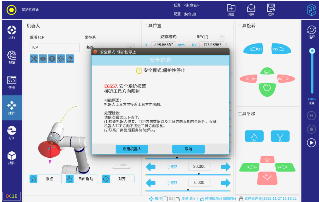
图 3-86: 安全系统报警（接近工具方向限制）
