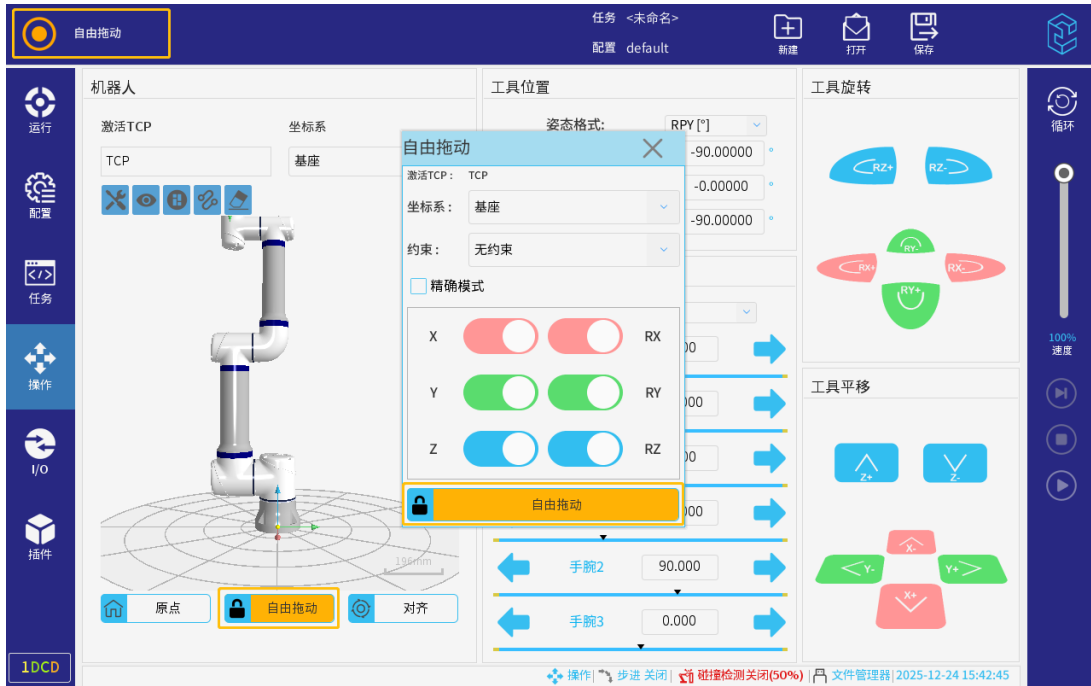
图 3-159: 自由拖动锁定（锁轴拖动模式下）
