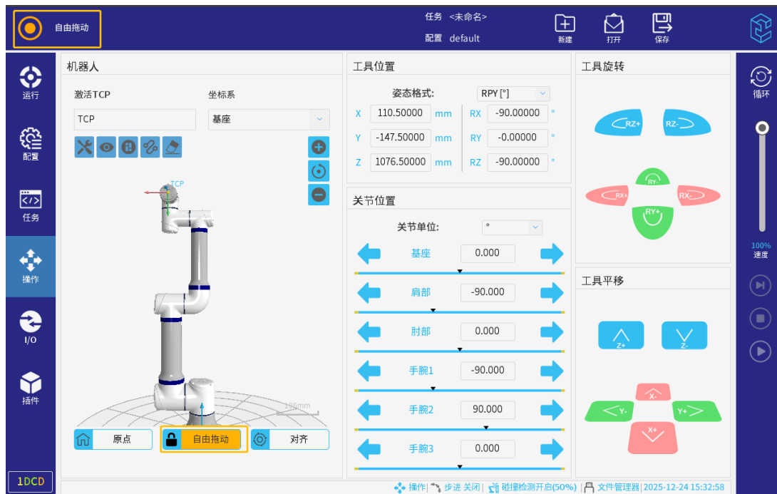
图 3-158: 自由拖动锁定（非锁轴拖动模式下）
