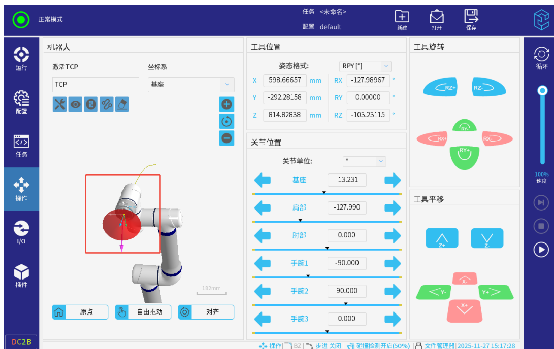
图 3-85: 工具方向模型红色提示
