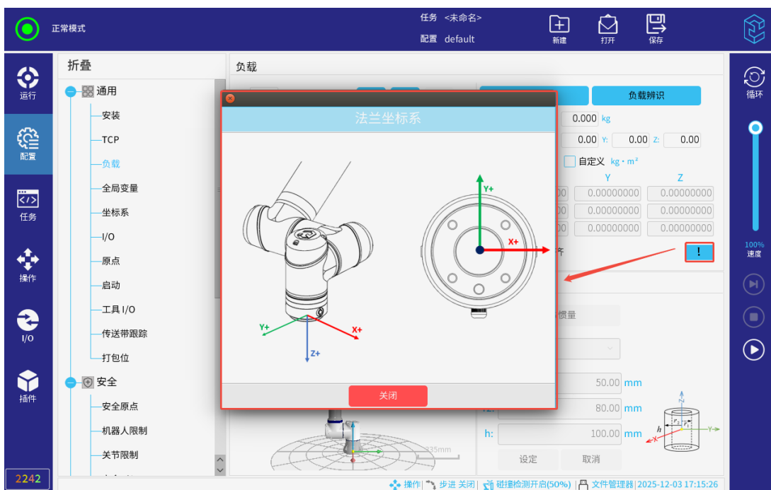
图 3-47: 法兰坐标系方向
