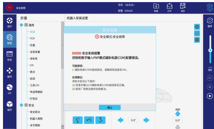
图 2-16: 安全系统报警 (PNP)
