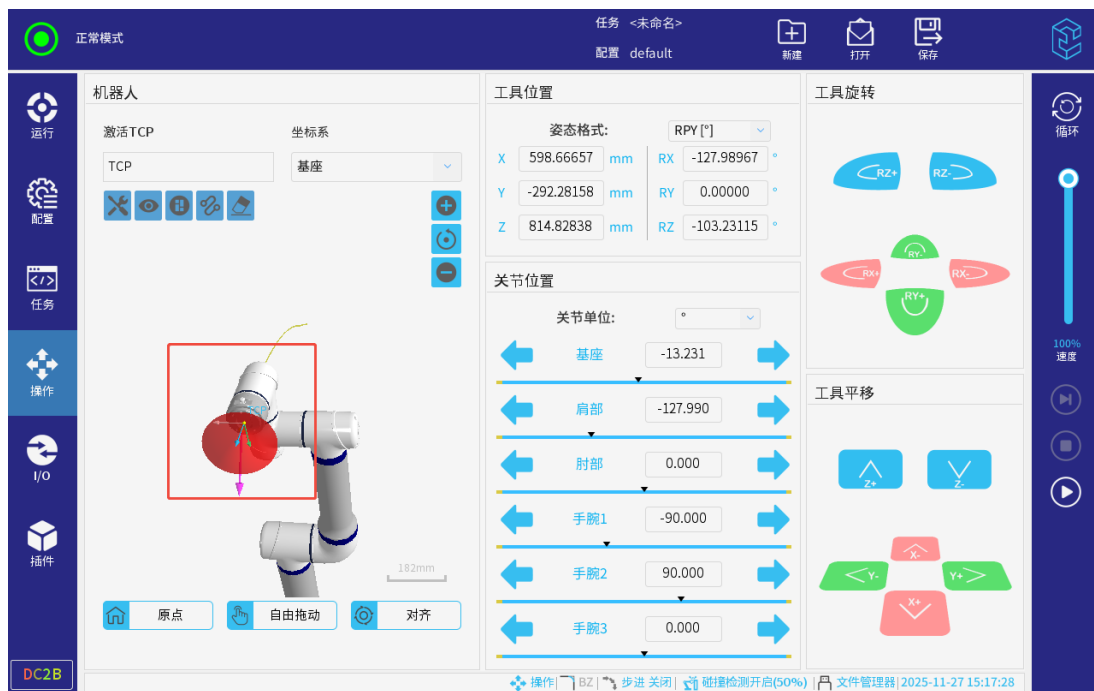
图 3-85: 工具方向模型红色提示
