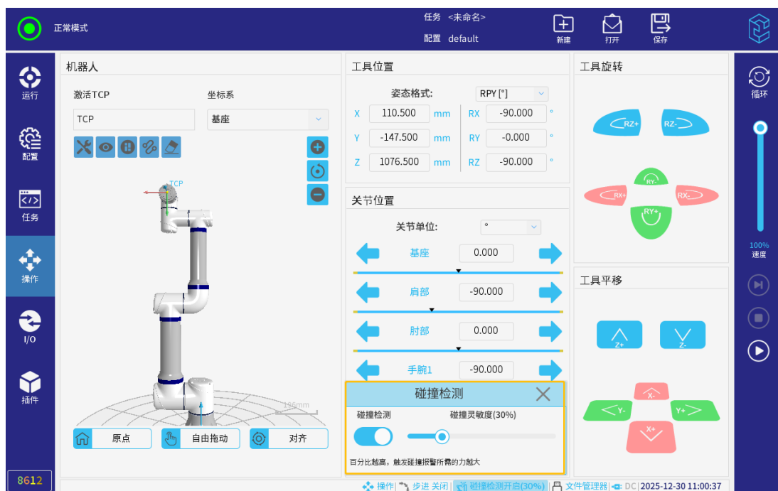
图 3-13: 开启碰撞检测
