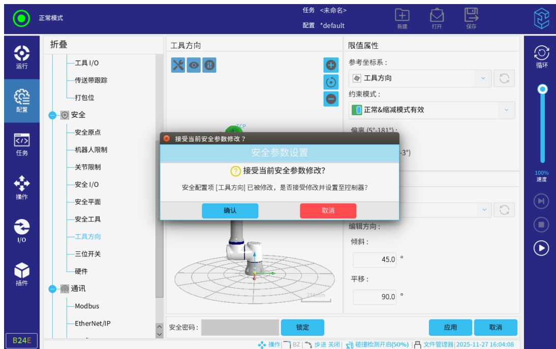
图 3-83: 应用工具方向的配置
