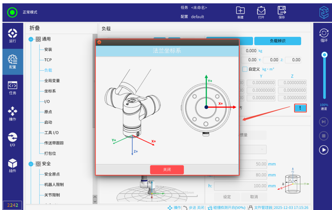
图 3-47: 法兰坐标系方向
