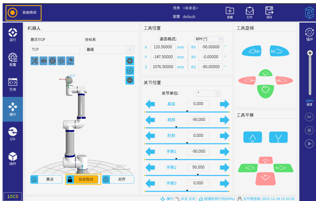
图 3-158: 自由拖动锁定（非锁轴拖动模式下）
