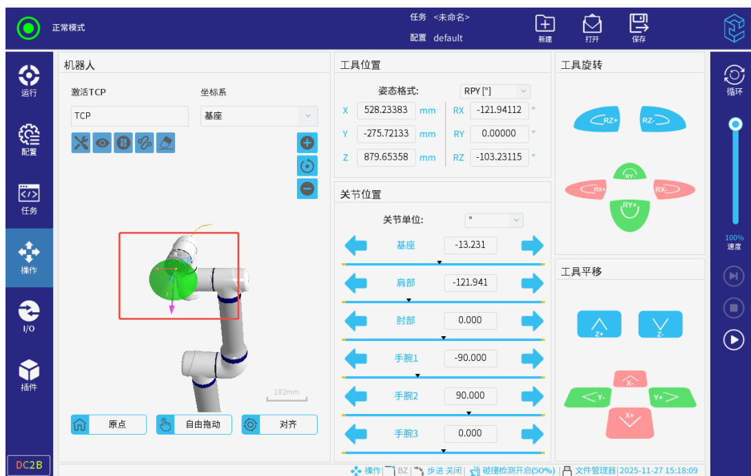
图 3-84: 工具方向模型绿色提示
