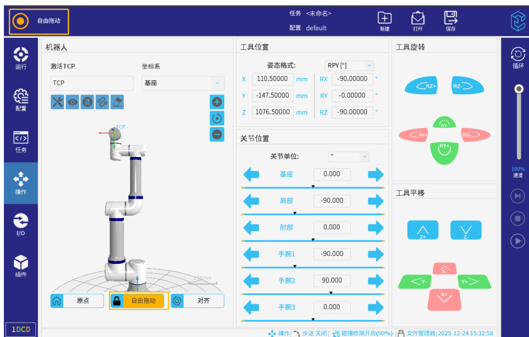
图 3-158: 自由拖动锁定（非锁轴拖动模式下）
