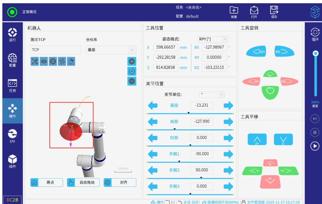
图 3-85: 工具方向模型红色提示
