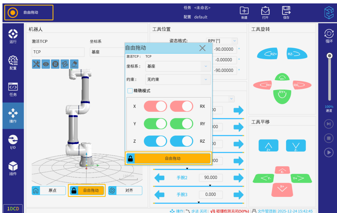
图 3-159: 自由拖动锁定（锁轴拖动模式下）
