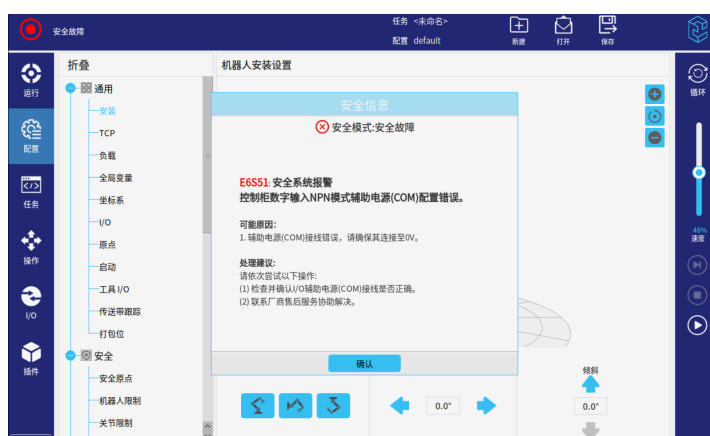
图 2-17: 安全系统报警 (NPN)
