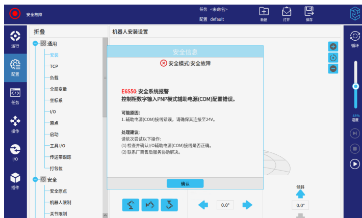
图 2-16: 安全系统报警 (PNP)
