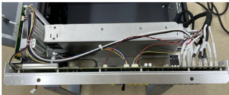
图 3-33: 取出安装模块
