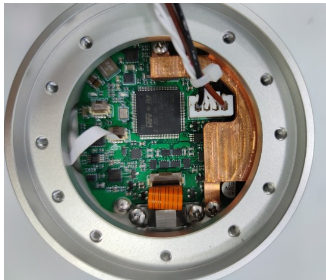
图 3-16: 连接手腕 3 关节和末端法兰的电线
