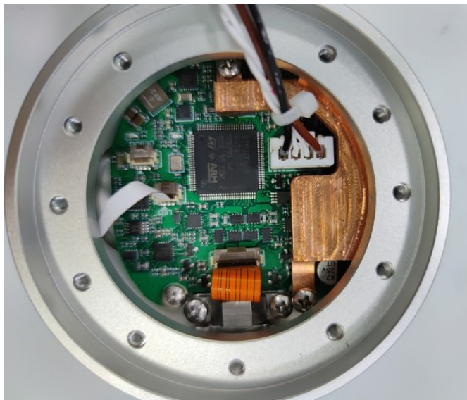
图 3-16: 连接手腕 3 关节和末端法兰的电线
