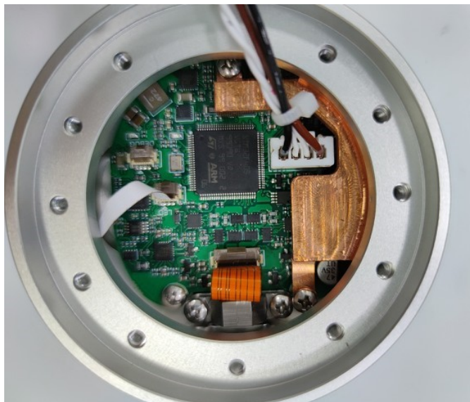
图 3-16: 连接手腕 3 关节和末端法兰的电线
