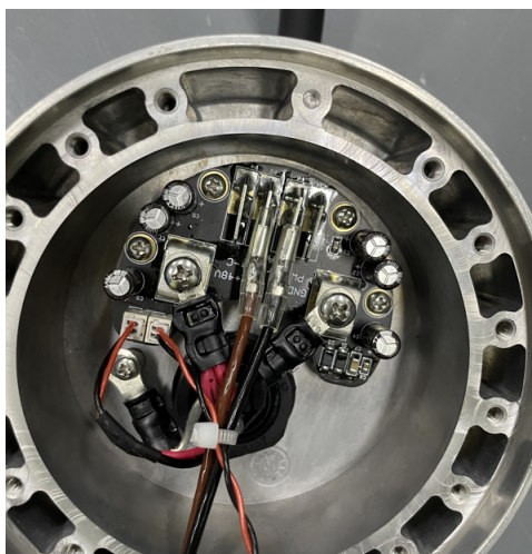
图 3-8: 连接基座关节线
