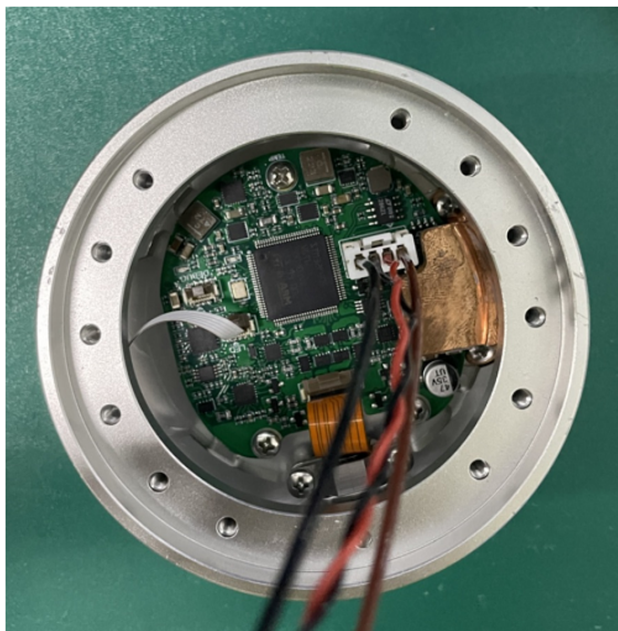
图 3-16: 连接手腕 3 关节和末端法兰的电线
