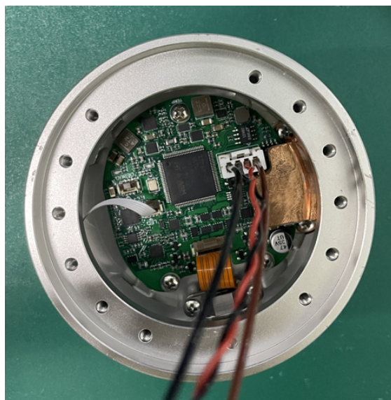
图 3-16: 连接手腕 3 关节和末端法兰的电线
